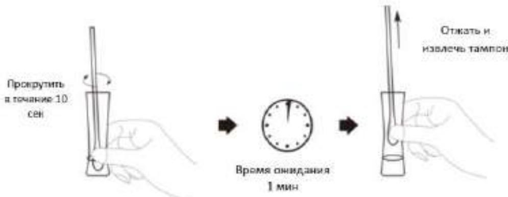
6.10 Извлечь тампон, одновременно прижимая головку тампона к внутренней стенке пробирки, чтобы удалить из него как можно больше жидкости. После использования тампон утилизировать в соответствии с вашим протоколом удаления биологически опасных отходов;
